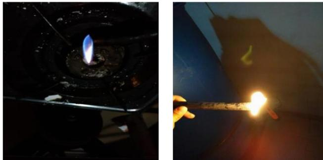
Gambar 5. Pegujian Pembakaran Biogas
