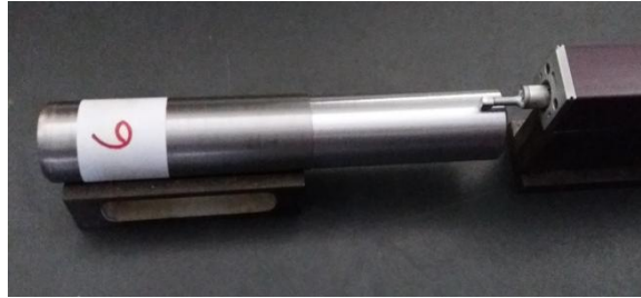
Gambar 2. Hasil pemotongan dengan gerakan pemakanan 0,035 mm/putaran
