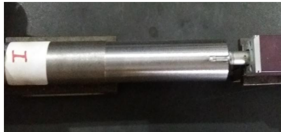
Gambar 3. Hasil penyayatan dengan gerakan pemakanan 0,07 mm/putaran
