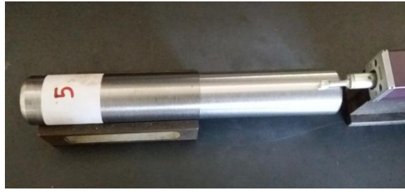
Gambar 1. Hasil pemotongan dengan gerakan pemakanan 0,07 mm/putaran
