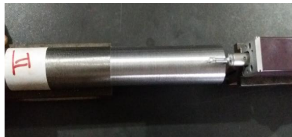
Gambar 4. Hasil penyayatan dengan gerakan pemakanan 0,035 mm/putaran
